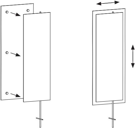
⑤ Federstahl-Clips auf Lichtprofilenden schieben,
