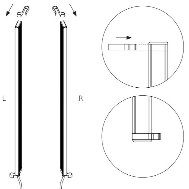
⑥ Lichtprofil mit Clip an Seitenflügel befestigen
